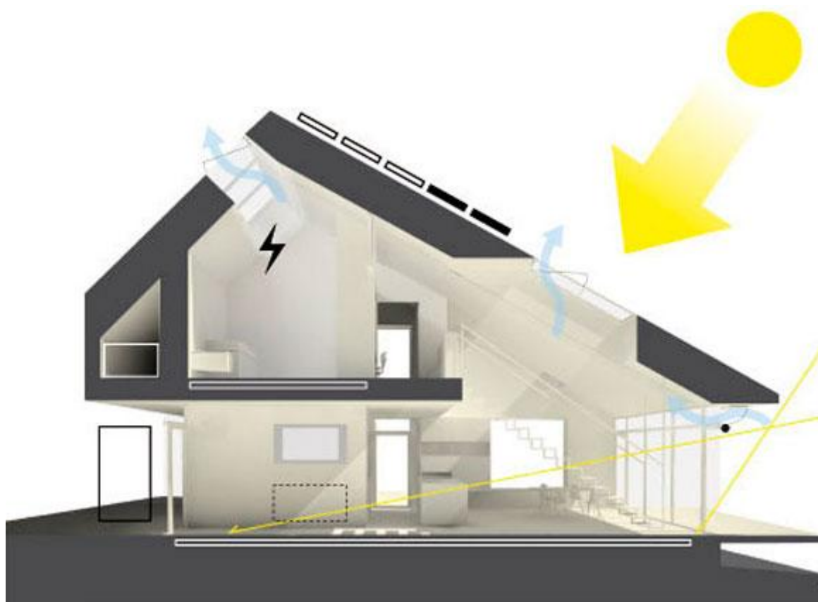
Obrázok 2 Princíp fungovania experimentálnej budovy "Home for Life" (VELUX group, 2009)
