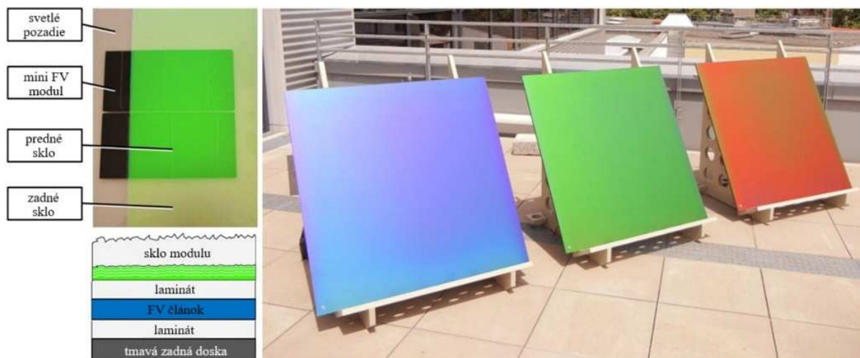
Obr. 4.14 FV moduly so spektrálne selektívnou štruktúrou MorphoColor umiestnenou na vnútornej strane predného krytu [55]
