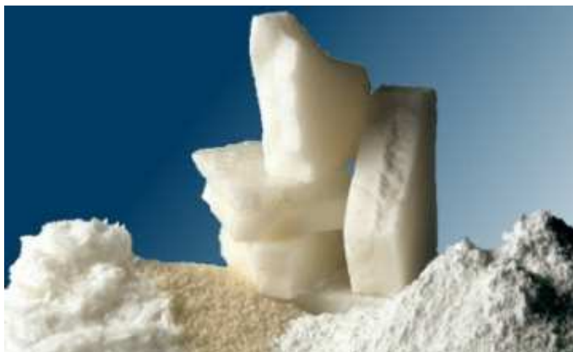
Obr. 4.26 Organické PCM na báze parafínov od firmy RUBITHERM [66]
