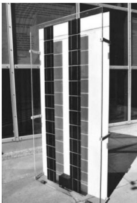
Obr. 4.39 Bifaciálny modul s bielou reflexnou fóliou [80]
