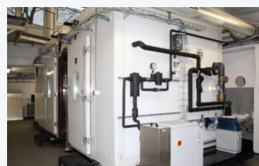
Veľká klimatická komora pre synergický výskum šírenia tepla, difúzie vodnej pary a infiltrácie vzduchu / Big climatic chamber for synergic research of heat transfer, diffusion of water vapour and air infiltration
