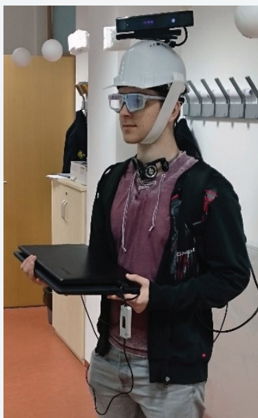
Získanie RGB-D dát so zariadením Kinect (na prilbe). Eye tracker SMI Sledovač očí (na očiach).
