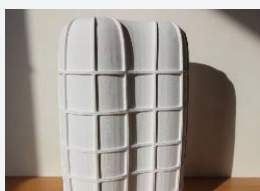
Pohľad na budovu vytlačenú v mierke 1:300 pomocou 3D tlačiarne / The view of 3D printed building in 1:300 scale
