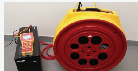
Pohľad na ventilátor s centrálnou jednotkou a diferenciálnym tlakomerom - súčasť zariadenia pre blower door test / The view of the fan with central unit and differential pressure gauge - a part of the device for the blower door test
