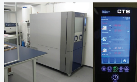
Pohľad na komoru pre výskum spoľahlivosti striech / The view of the chamber for research of reliability of roofs
