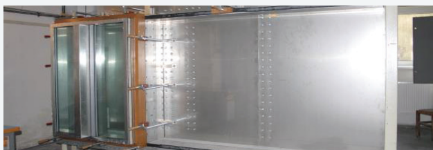
Pohľad na veľkú tlakovú komoru pre výskum filtrácie vzduchu detailmi alebo prvkami (okná, zasklené steny) obalových konštrukcií / The view of the big pressure chamber for research of air filtration through details or elements (windows, glass walls) of envelope constructions of buildings
