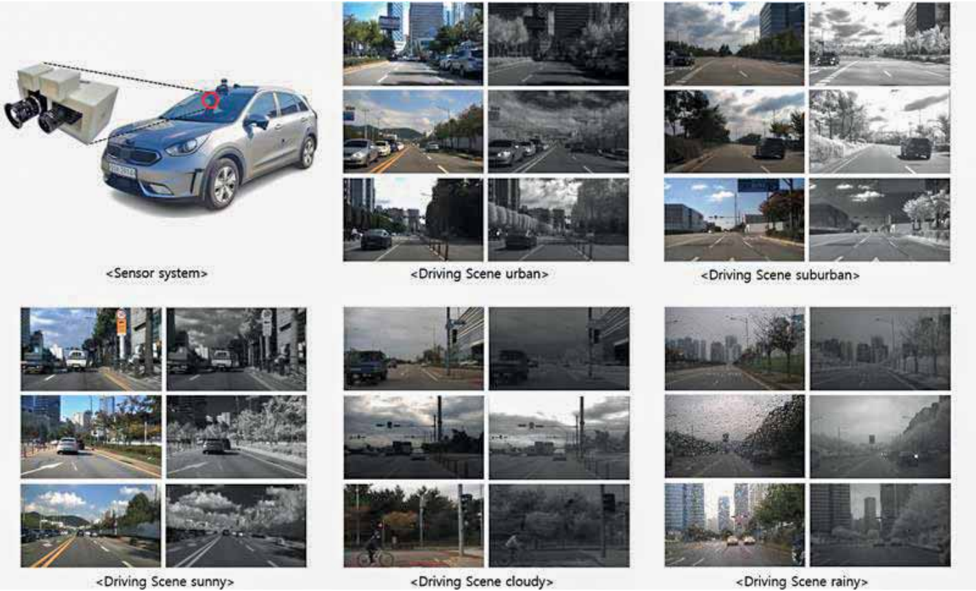
↑ Zber dát z multispektrálnej a RGB kamery v autonómnom vozidle. Ilustrácia znázorňuje senzorický systém vozidla vybavený viacerými kamerami, ktoré snímajú rôzne jazdné prostredia (mestské, prímestské, za rôznych svetelných a poveternostných podmienok). Tieto dáta sú využívané pri tré­novaní algoritmov počítačového videnia.
