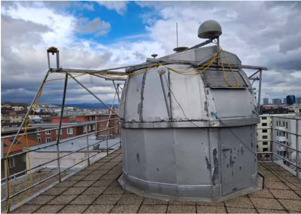
↑ Na vrchu kupoly sú na špeciálnej konštrukcii upevnené antény, ktoré neustále prijímajú signály z navigačných družíc.
