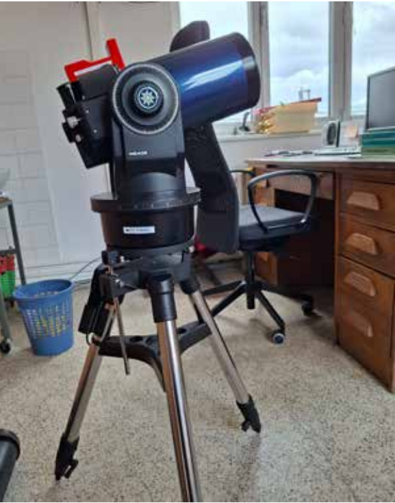
↑ Zrkadlový teleskop (reflektor). Svetlo sa tu pri prechode tubusom ďalekohľadu viackrát odráža, čím sa jeho dráha predlžuje, a to umožňuje väčšie zväčšenia pozorovaného objektu pri zachovaní menších rozmerov teleskopu.
