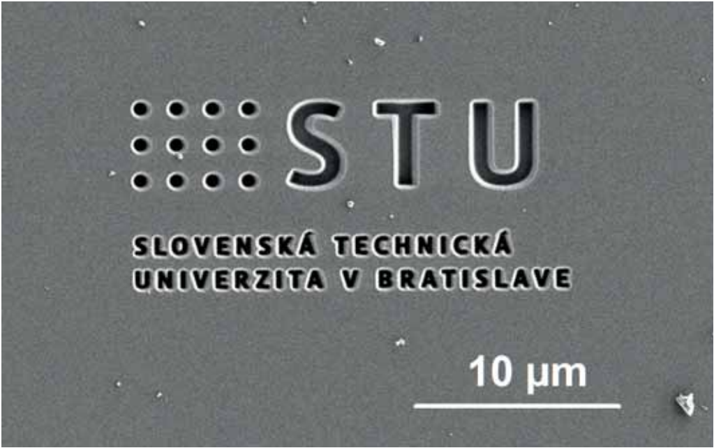
↑ Nanopatterning pomocou fokusovaného iónového zväzku na kremíkovom substráte Zdroj foto: Nanocentrum
