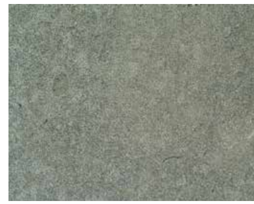
Štruktúra vysokovýkonnej rýchloreznej nástrojovej W-Mo-Co ocele po izostatickom lisovaní za tepla
