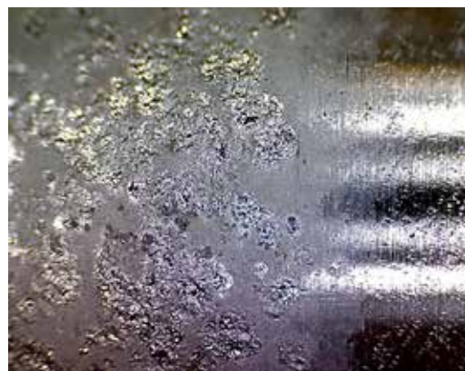
Rozhranie ESD deponovanej vrstvy Inconelu 713LC a substrátu ocele AISI 310
