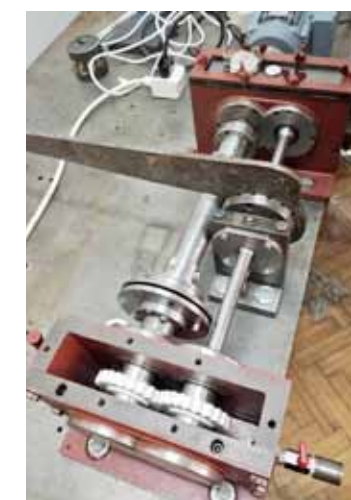
Testovacie zariadenie pre ozubené kolesá
