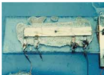
Prvý funkčný integrovaný obvod vytvorený Jackom Kilbom, testovaný 12. septembra 1958, pozostávajúci z tranzistora a ďalších komponentov na kúsku germánia. Rozmery obvodu: 11,1mm × 1,6mm.
