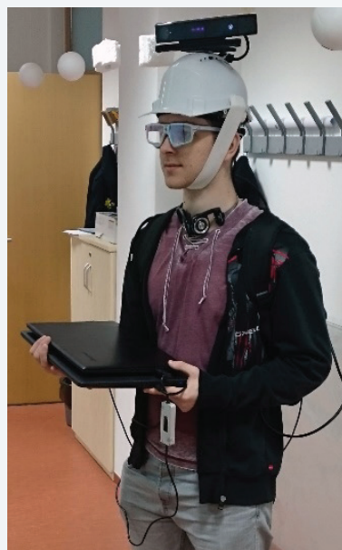
Získanie RGB-D dát so zariadením Kinect (na príbse). Eye tracker SMI Sledovač očí (na očiach).
