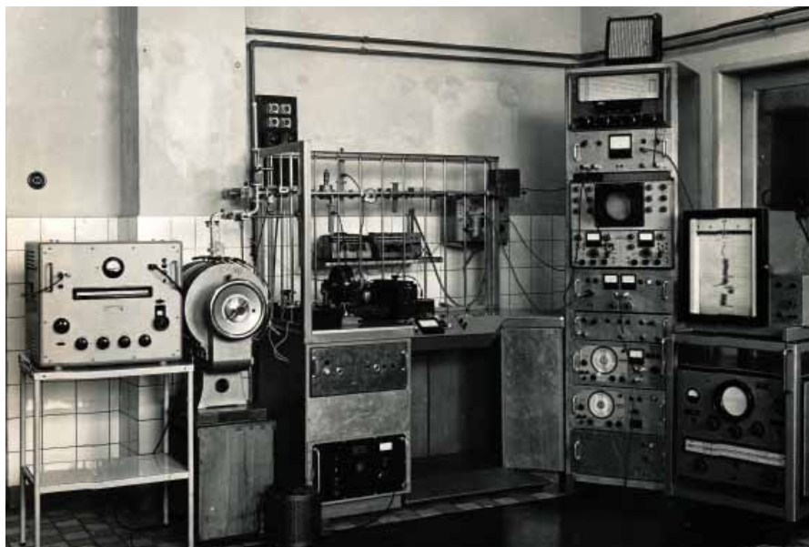
EPR spektrometer postavený na Katedre fyzikálnej chémie v rokoch 1960.
