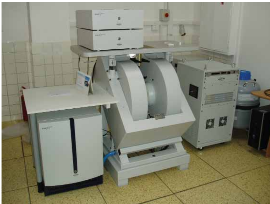
EPR spektrometer EMX Plus pracujúci v X- a Q-pásme.
