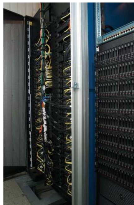
Server IBM System x i DataPlex dx360 M3, počet výpočtových jadier bez GPU 576, počet výpočtových jadier s GPU 48, pamäť na jadro 4GB, kapacita externého úložiska dát 115,2 TB, operačný systém Scientific Linux.
