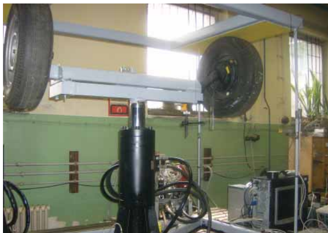
Detail rámu na skúšanie automobilových náprav, tenzometrická aparatúra a zaťažovací rám na riadené skúšky vzoriek materiálov.
