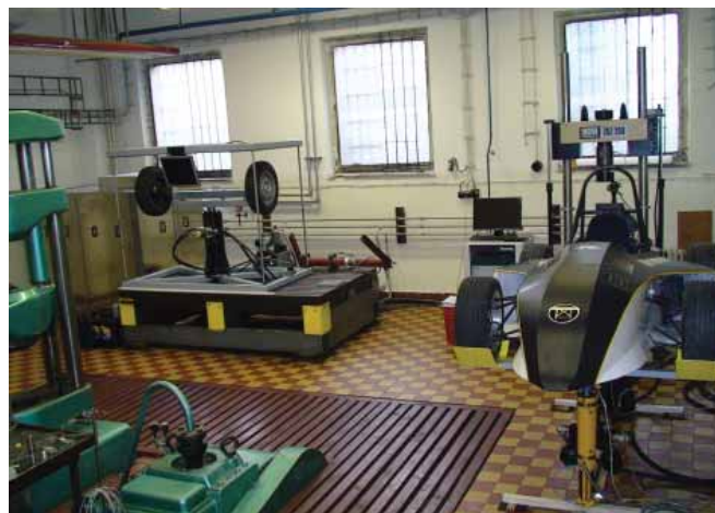
Pohľad na časť laboratória: vľavo elektromechanický lis a pulzátor 1000 kN, vľadu stend pre skúšanie automobilových náprav, vpravo vľadu rám pre riadené skúšky vzoriek materiálov, v popredí testovanie prvej študentskej formuly (Hockenheim 2009) na vibračnej stolici.
