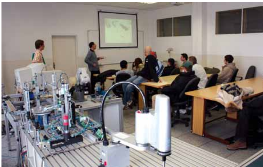
Priemyselné roboty mladých ľudí vždy zaujmú. V popredí možno identifikovať robot s kinematikou SCARA a automatizovaný montážny systém na Ústave výrobných systémov, environmentálnej techniky a manažmentu kvality.
