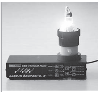
Model opticko-tepelnej sústavy.
